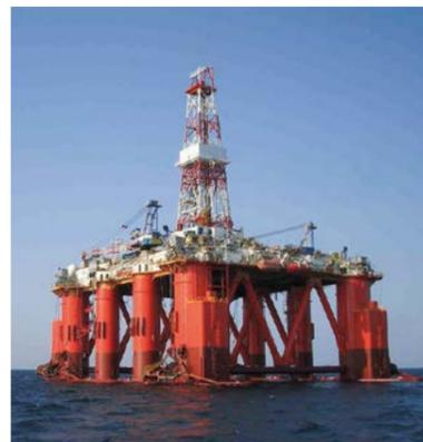
④浜田沖天然ガス試掘調査に使われた海洋掘削リグ
